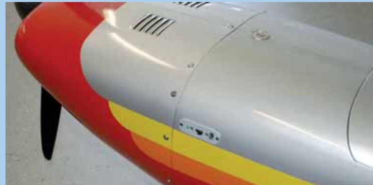
PowerBox 12, hier als Zündschalter für einen 4 Zylinder 3W Motor, beide Zündungen werden redundant über zwei Akkus versorgt.
