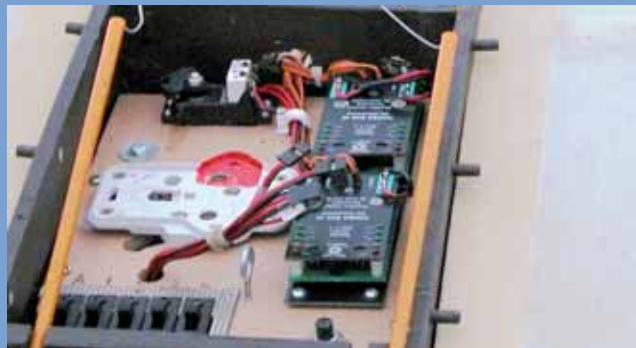
In diesem Oldtimer versorgen zwei PowerBox Basic redundant zwei Empfängersysteme.
