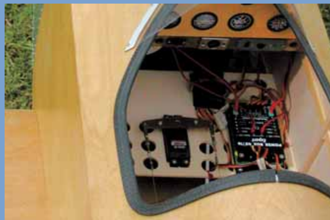
Eine Klemm 35, ausgestattet mit PowerBox Expert und PowerSchaltern
