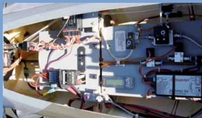
Mark Hinton, England, vertraut in seinem F 104 Starfighter der Stromversorgung PowerBox Gemini und einer 2,4 GHz RC-Anlage von Futaba.
