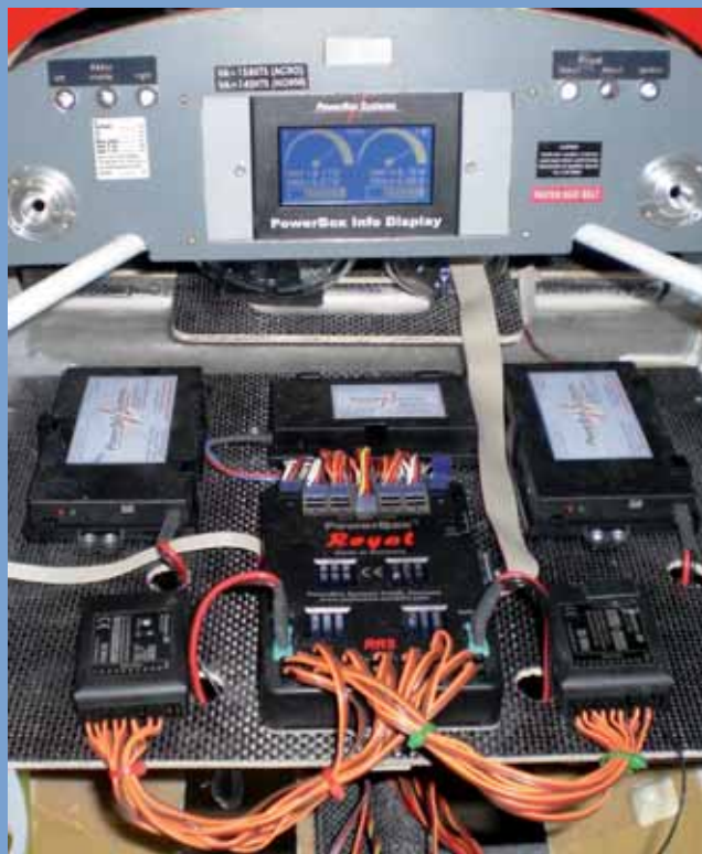
Einbau der PowerBox Royal in einer von Werner Lewandowski gebauten Extra von Composite ARF. Das beleuchtete LC-Display wurde hier perfekt in das Cockpit integriert.
