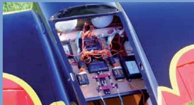
Perfekt im Rumpf der Delro „Raven“ platziert, der übersichtliche Einbau der PowerBox Royal und der PowerBox Battery. Gut zu erkennen auch die beiden Futaba Empfänger die redundant von der PowerBox Royal verwaltet werden. Glückwunsch an Michael Bluhm aus Merzen.
