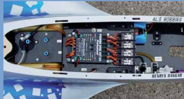
PowerBox Professional mit den beiden PowerSchaltern im Jet von Al Machinsky, England
