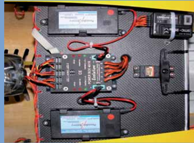
Günther Hölzlwimmer wählte als Stromversorgung in seiner Composit ARF Extra mit 2,30 m Spannweite die PowerBox Evolution
