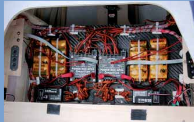
Die „große“ Pitts, ein Bausatz von Harald Weiherhäuser, im Besitz von Peter Hartmann, Schweiz, hat sämtliche RC-Systeme doppelt. Zwei Empfänger, zwei PowerBox Competition, zwei SensorSchalter.
