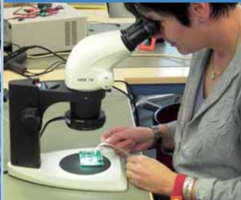
Optische Prüfung der elektronischen Bauteile
