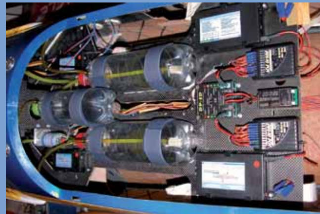
Yak 55 von Composite ARF von Günther Hölzlwimmer mit den beiden RC Akkus PowerBox Battery 2800. Im vorderen Bild zu erkennen: die beiden PowerBox Battery 1500 für die Zündung des 3W 4-Zylinder-Motors und die Smokepump.
