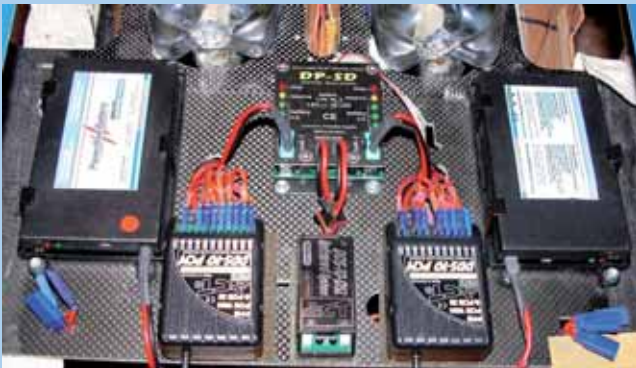
Yak 55 mit 3,3 m Spannweite von Composite ARF von Günther Hölzlzimmer zeigt den vorbildlichen Einbau aller RC-Komponenten mit den PowerBox Batteries und der PowerBox DP-SD, die beide ACT-Diversity-Empfänger versorgt
