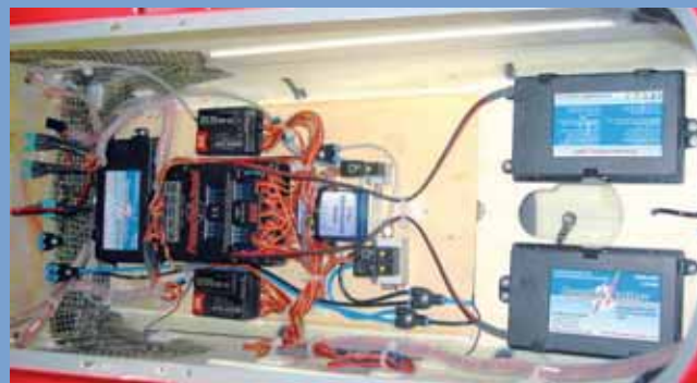
Rainer Kamitz vertraut in seinen Jetmodellen dem System PowerBox, PowerBox Royal mit RRS, hier angeschlossen zwei Graupner DS 20 mc Empfänger und PowerBox Battery 2800 für die Stromversorgung der RC Anlage und der Turbine.
